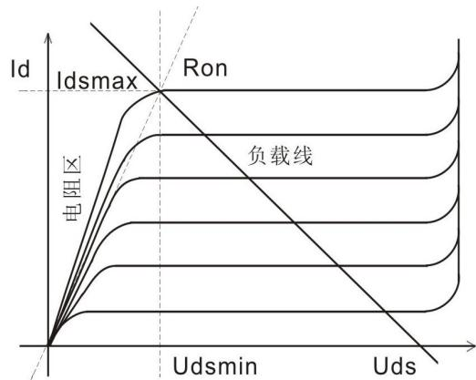
在 10V 栅极电压  $U_g$  下 Vmos 管由可调电阻区进入饱和区时的直流电阻为通态电阻  $R_{on}$ 。
