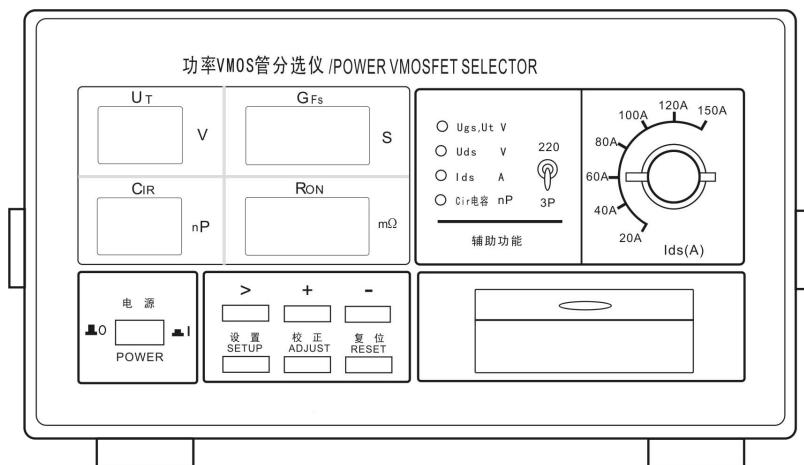
2、对测试的 Vmos 管的通态电阻 Ron，开启电压 Ut，跨导 Gfs，极间电容 Cir 可以进行超极限判断，不符合设定要求的发出报警声，并且显示的数值闪动，指示哪一项不合格。
