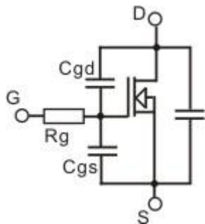
一般是在漏极加 10V 电压, 棚极电压为 0V, 测量出。大电流管主要是栅源极电容 Cirr, (有的叫 Cgs)取决于激励功率。
