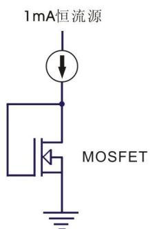
工业应用中，常常将漏棚短路条件下  $I_d=1\text{mA}$  的栅极电压定义为开启电压。
