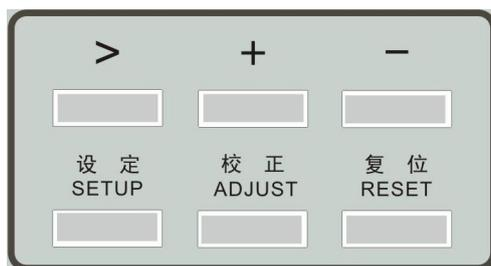
设定键 (SETUP)，移位键 (>)，加键 (+) 和减键 (-)。在设定状态下，按移位键
