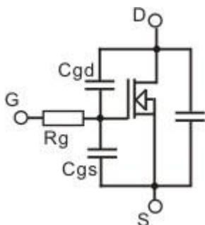
一般是在漏极加 10V 电压，栅极电压为 0V，测量出。大电流管主要是栅源极电容  $C_{irr}$ ，(有的叫  $C_{gs}$ )取决于激励功率。
