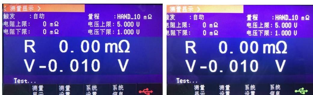
●U盘插入USB接口中，按USB图标下面的功能键，界面USB接口图标变为绿色，则表示数据存入U盘中，然后就可以拔出U盘。
