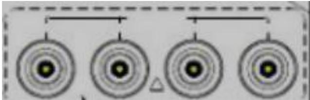
为了确保仪器所能达到的精度，请使用随机附带的“开尔文”测试夹进行测试。
