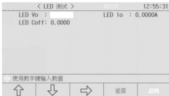
CR-LED 测试模式可以真实模拟 LED 灯的特性，通过增加二极管的导通电压设置，完全模拟二极管的工作原理，使测试电压及电流达到一个正常的稳定值，避免了传统定电阻模式下电压及电流不稳定或产生震荡的情况，真实的反映 LED 驱动电源的实际带载情况。
