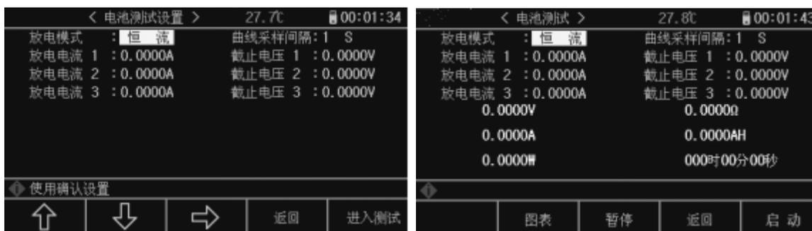
放电测试可以以定电流或定电阻方式工作，以测定电池类电源的放电时间及容量；持续放电过程中，电池电压不断跌落，当负载输入电压低于设定值时，放电测试自动停止，仪器可显示放电时间及电池容量。仪器最多可以设置三档放电电流及截止电压，以能更好的模拟实际电池在不同电流应用下的状态，放电电流 1 在达到条件后会自动转为 2 直至 3，所以在设置截止电压时也要按电压下降梯度，截止电压 3 不能高于 2 不能高于 1。
