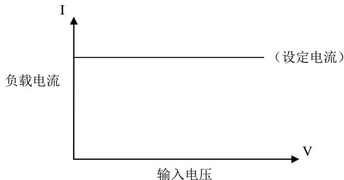
按【定电流】键进入定电流模式，该按键灯亮起，通过数字按键输入需要设定的电流值，输入的数字会在状态栏  $I_s = 0.0000A$  显示，输入完成后按【Ent】键确认。按【启动】键或【ON】键启动负载测量。
