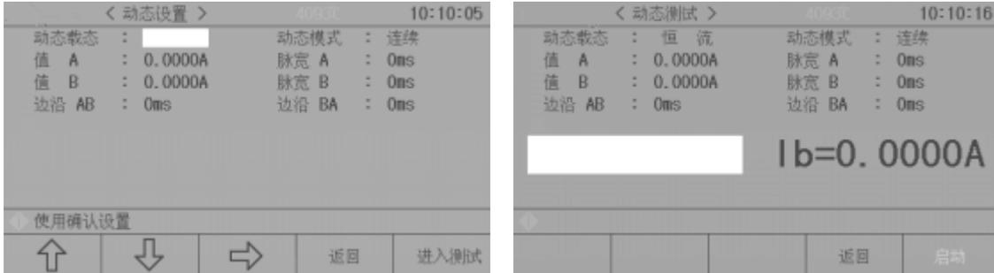
动态测试可使负载在两种电压或电流间反复切换，此功能可用来测试电源的动态特性。
