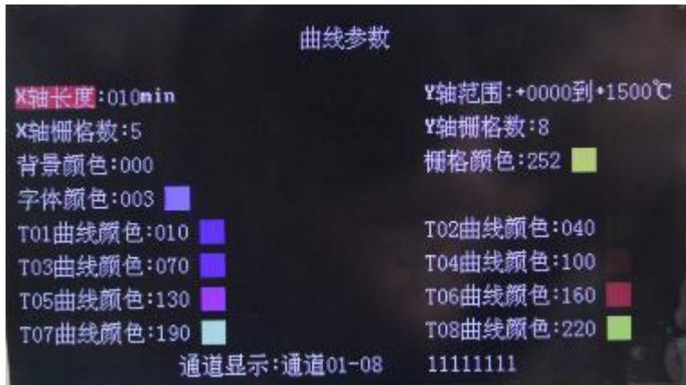
X轴长度：X轴时间值，1min~999min可自由设置。
